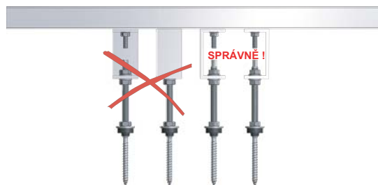
f) Šroub do střešní krytiny a jeho správné přichycení k „H“ profilu
