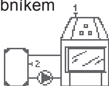
Kotel na pevná paliva se zásobníkem
