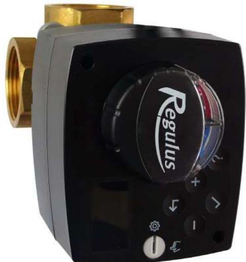
Při montáži do otopného systému ve svislé poloze musí být u levé instalace ventilu (zkratové potrubí směšovacího ventilu doleva) červená značka na štítku vpravo (viz obr. 8) a u pravé instalace (zkratové potrubí směšovacího ventilu doprava) červená značka na štítku vlevo (viz obr. 9).
