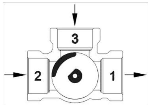
PŘEPÍNAČ RUČNÍHO OVLÁDÁNÍ - OTOČTE O  $90^\circ$  (ruční ovládání)
