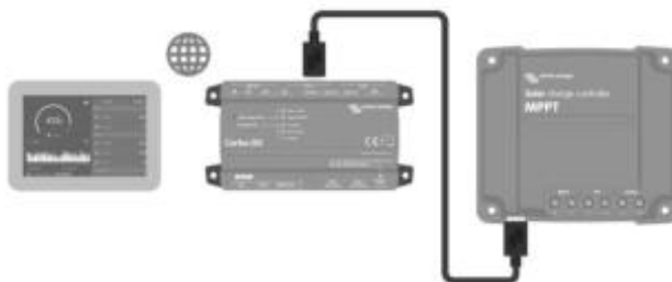
Připojení aplikace VictronConnect přes LAN nebo internet (portál VRM) pomocí zařízení GX (například Cerbo GX)
