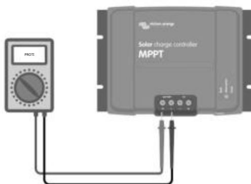
Měření napětí baterie na svorkách baterie ovladače
