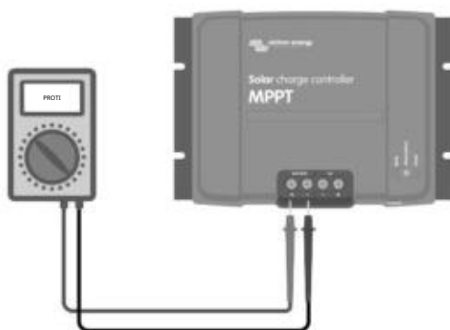
Měření napětí baterie na svorkách baterie ovladače
