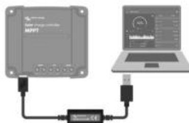
Připojení aplikace VictronConnect přes USB pomocí rozhraní VE.Direct USB
