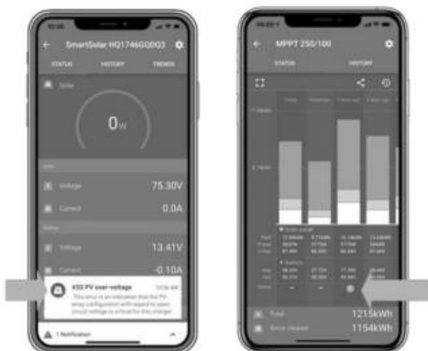
VictronConnect: snímek obrazovky s chybou #33 a snímek obrazovky s historií indikující chybu
