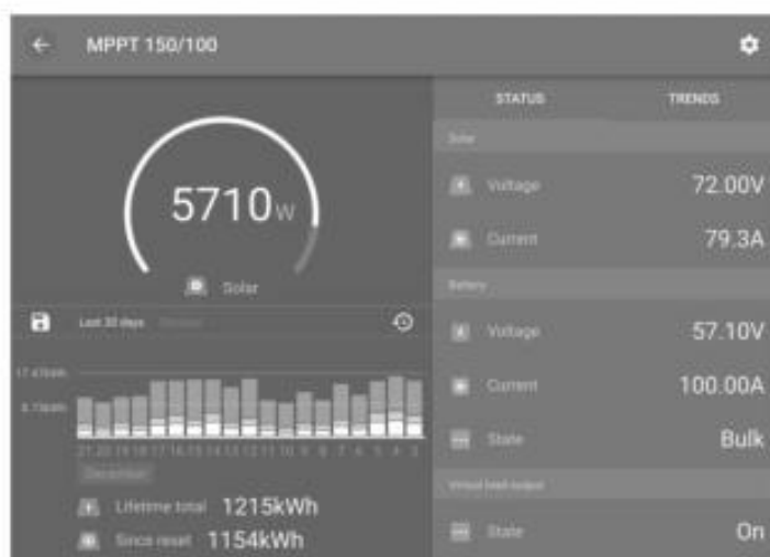
Snímek obrazovky aplikace VictronConnect, zobrazující data v reálném čase a historická data
