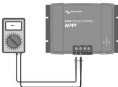
Měření napětí baterie na svorkách baterie ovladače
