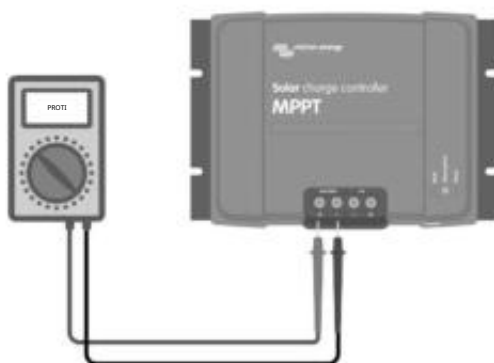
Měření napětí baterie na svorkách baterie ovladače
