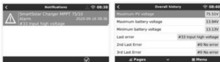
Zařízení GX zobrazující upozornění na alarm a historické chyby.
