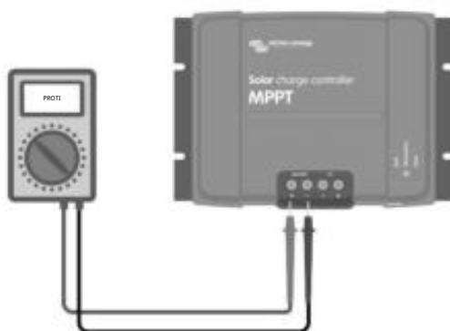
Měření napětí baterie na svorkách baterie ovladače
