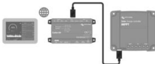
Připojení aplikace VictronConnect přes LAN nebo internet (portál VRM) pomocí zařízení GX (například Cerbo GX)
