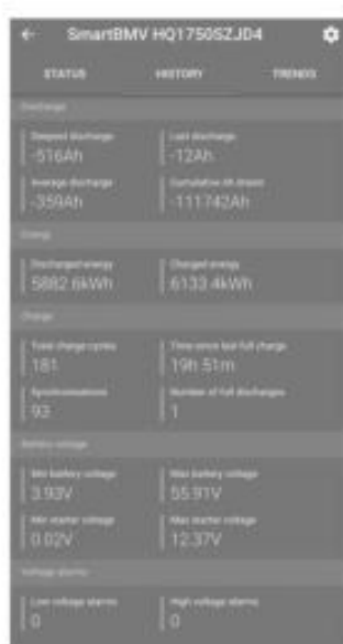
Aplikace VictronConnect zobrazující historii monitoru baterie BMV
