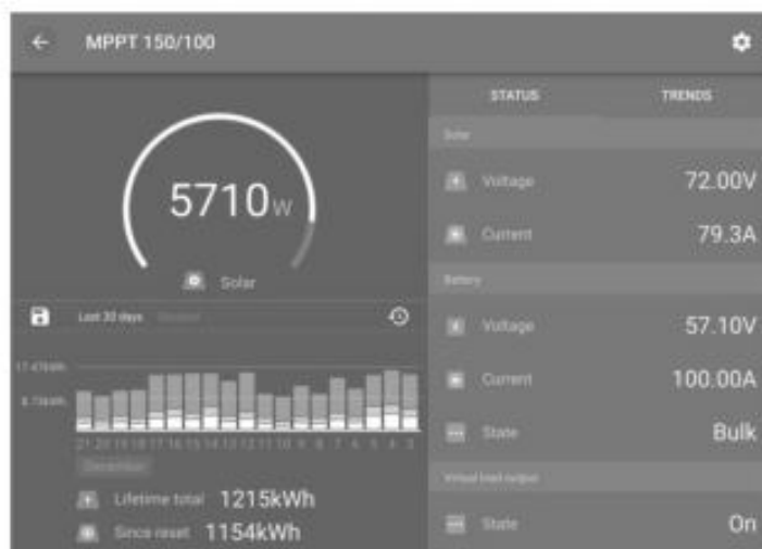
Snímek obrazovky aplikace VictronConnect, zobrazující data v reálném čase a historická data
