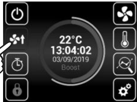
Režim BOOST se aktivuje stiskem symbolu na obrázku V poli režimu větrání se zobrazí režim BOOST
