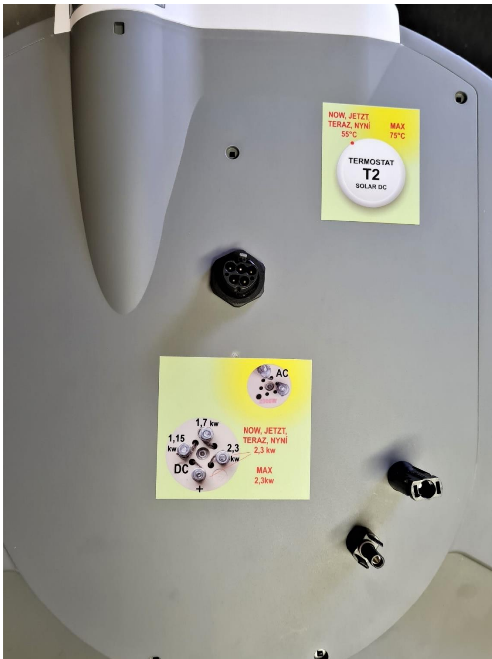
Obr.č.4 Plastový kryt elektroinstalace umístěn na spodní části zásobníku vody
