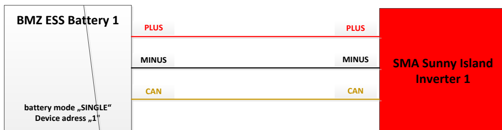
Obrázek 4-18 : Jednofázový provoz s jednou baterií ESS
