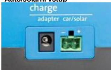
K auto/solárnímu vstupu lze připojit zdroj 11 až 25 VDC pro nabíjení PPP z elektrického obvodu tažného vozu, 12V solárního panelu nebo 12V baterie. Při připojení k přívěsu automobilu zástrčku, použitý kontakt musí být pečlivě vybrán, aby nedošlo k přetížení žádného obvodu nebo nadměrnému vybití autobaterie.
