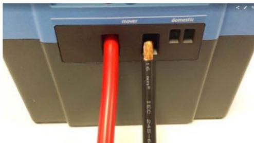
Det är mycket viktigt att kablar installeras noggrant på grund av de höga strömmar som förekommer när movern är i drift. Om kablar inte är korrekt anslutna kan det leda till sämre prestanda, överhettning eller skada. Victrons PPP är utrustad med högeffektspoler som ger en pålitlig anslutning med tunna tvinnade kabeländnar. Det krävs därför inga högklassiga bottenkontakter eller kontaktpressningsverktyg. Det går inte att koppla producten korrekt med solida kablar nebo kablar med tjocka trådar.
