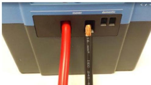
Vzhledem k vysokým proudům spojeným s provozem stěrače je zásadní pečlivá instalace kabelů. Nesprávné připojení kabelů může způsobit ztrátu výkonu, přehřátí a poškození. Victron PPP je vybaven vysoce výkonnými svorkami, které mohou zajistit spolehlivé spojení na koncích s jemnými lanky. Proto nejsou potřeba vysoce kvalitní očka a speciální lisovací nástroje. Pevný drát nebo dráty s silné prameny neposkytnou správné spojení.
