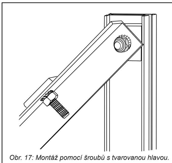
Obr. 17: Montáž pomocí šroubů s tvarovanou hlavou.
