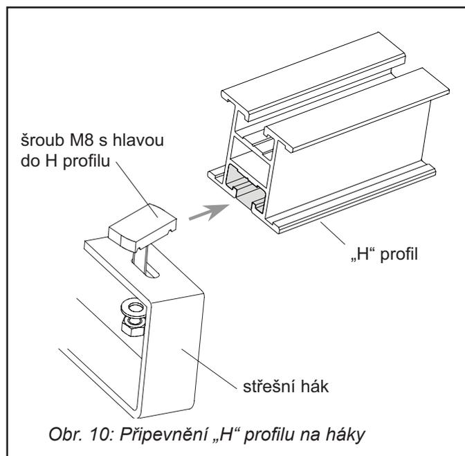
Obr. 10: Připevnění „H“ profilu na háky
