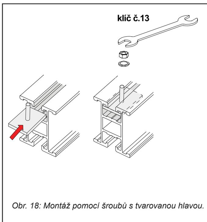
Obr. 18: Montáž pomocí šroubů s tvarovanou hlavou.
