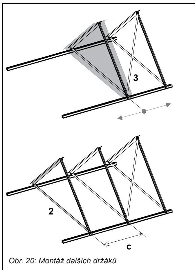
Obr. 20: Montáž dalších držáků
