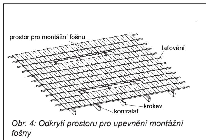
Obr. 4: Odkrytí prostoru pro upevnění montážní fošny
