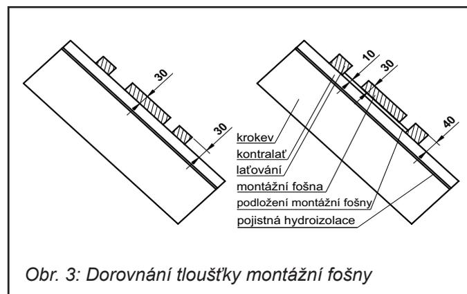
Obr. 3: Dorovnání tloušťky montážní fošny
