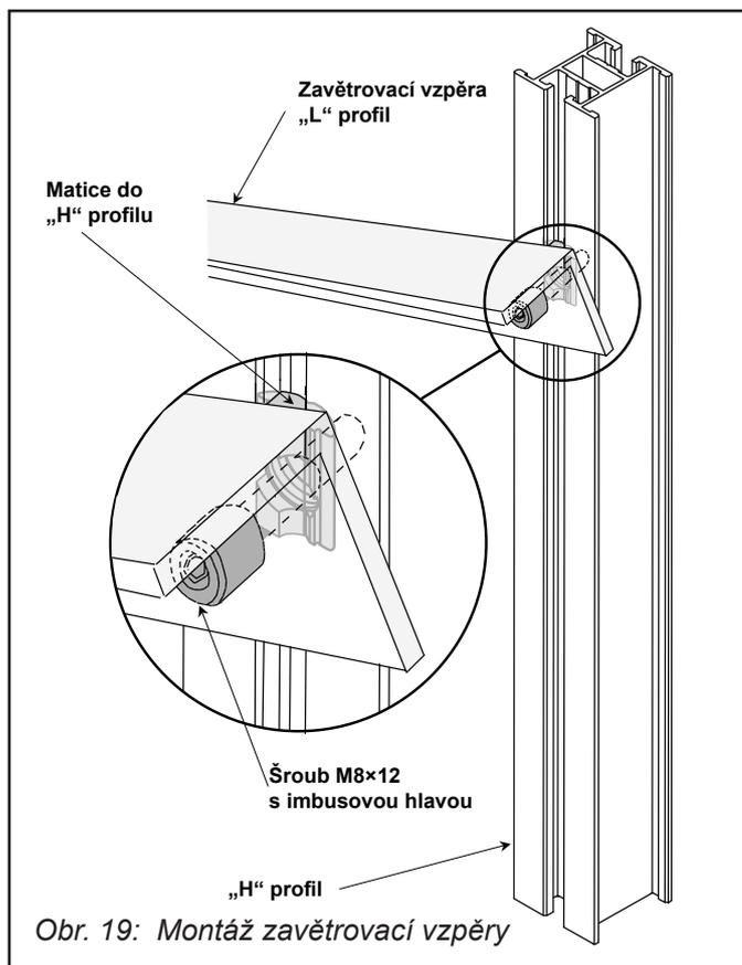
Obr. 19: Montáž zavětrovací vzpěry
