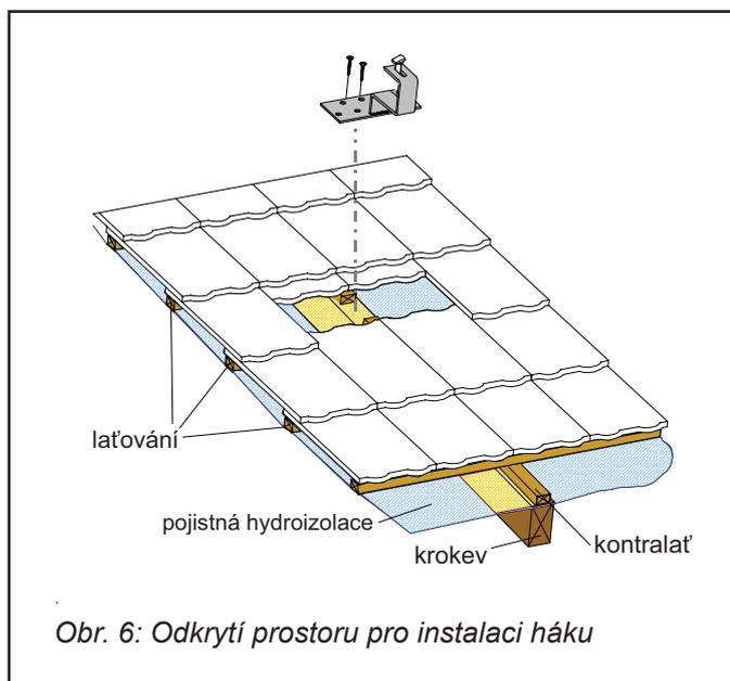
Obr. 6: Odkrytí prostoru pro instalaci háku
