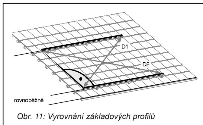
Obr. 11: Vyrovnání základových profilů
