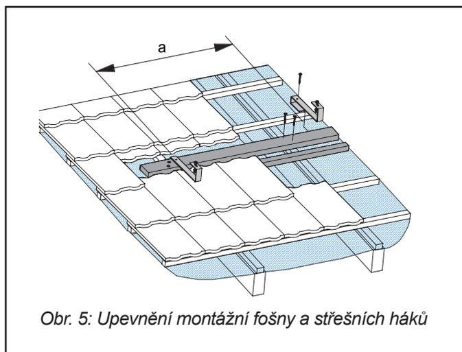
Obr. 5: Upevnění montážní fošny a střešních háků
